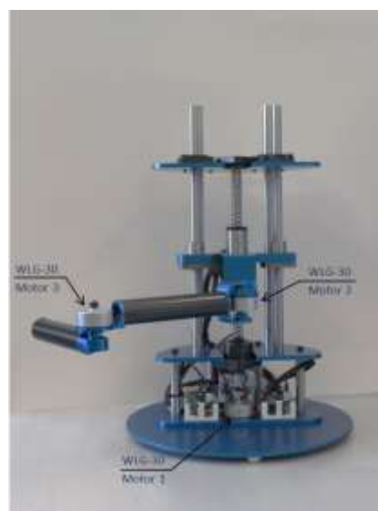
Petit robot rapide utilisant 3 moteurs WLG-30-R
